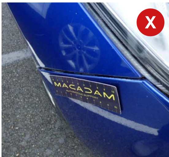
Pare-chocs AV / Dégrafé DÉPOSE/REPOSE
