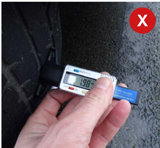
Pneu / Profondeur rainure < 4 mm À CHANGER
