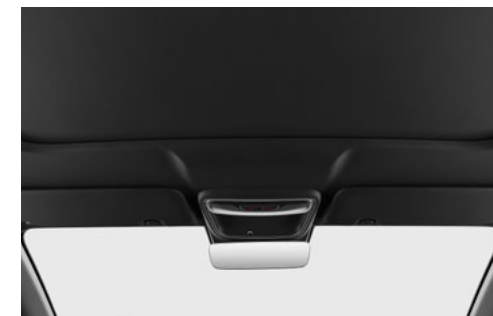
Elektrisk solafskærmning til panoramataget
