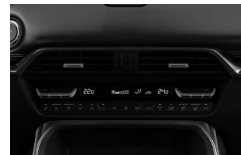
3-zone automatisk klimaanlæg
