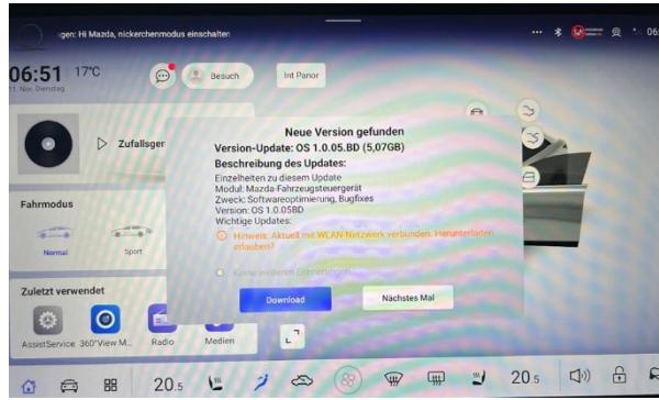
Diese Benachrichtigung wird nur angezeigt, wenn das Fahrzeug mit einem WLAN-Netzwerk verbunden ist (einschließlich Smartphone-Tethering).
