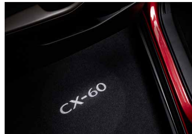
LED-TÜR-PROJEKTOR MIT CX-60-LOGO, PROJIZIERT DAS LOGO BEI GEÖFFNETER TÜR AUF DEN BODEN, FÜR FAHRER- UND BEIFAHRERTÜR CHF 366.-
