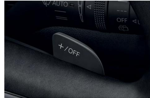
Lenkradwippen für die Wahl der Energie-Rekuperationsstufe
