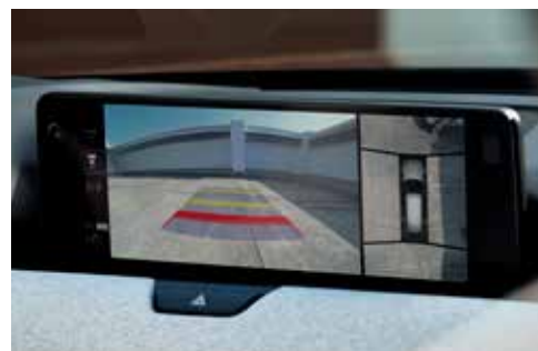
Caméra 360° avec fonction "See through" & vue sur l'attelage de remorque
