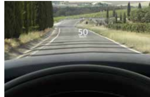
Affichage tête haute en couleur avec projection sur le pare-brise
