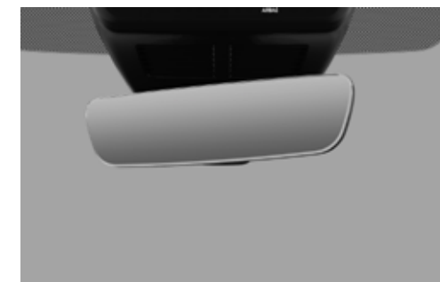
Rétroviseur intérieur sans cadre avec fonction anti-éblouissement automatique
