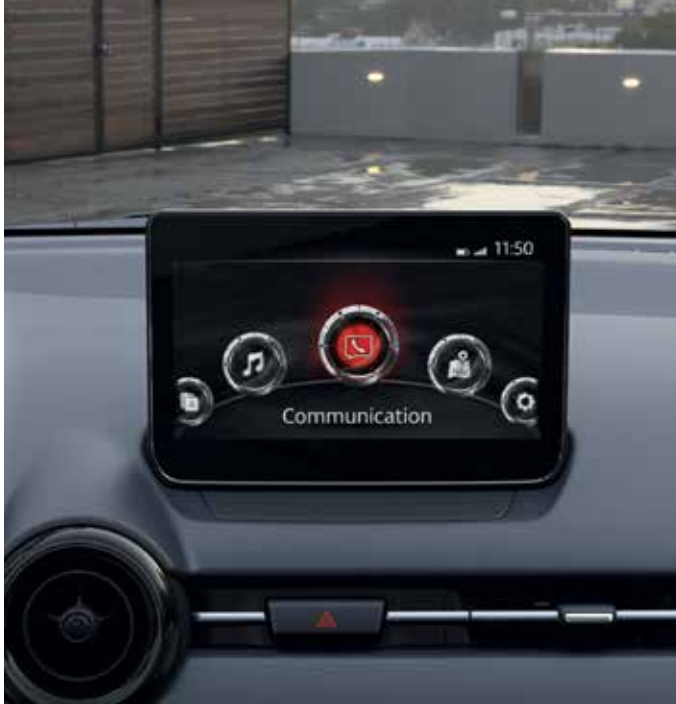
HMI Commander et MZD Connect avec écran couleur tactile 8"
