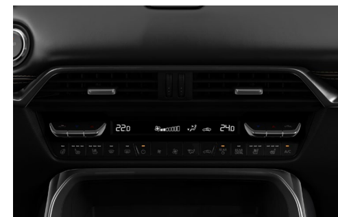
Climatizare pe trei zone
