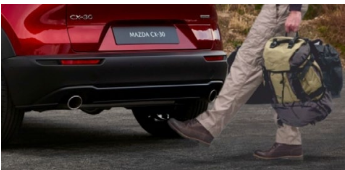
Moduł automatycznego otwierania/zamykania bagażnika poprzez ruch stopą
