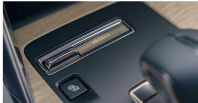
Sélecteur de mode de conduite Mazda Intelligent Drive (Mi-Drive)
