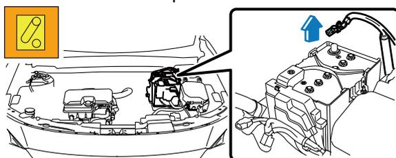
5) Die in der Abbildung gezeigte Relais entfernen.
