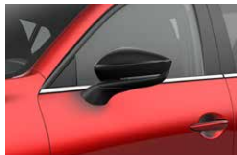
Elektrisch verstelbare, verwarmde en automatisch inklapbare buitenspiegels in 'Piano Black'
