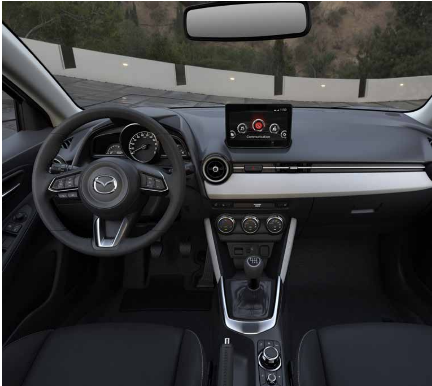
Zetelbekleding in zwart stof met grijze stiknaad, inleg dashboard in Pure White (afhankelijk van koetswerkkleur) en afwerking in gesatineerd chroom, inleg ventilatiemonden in zwart en wit
