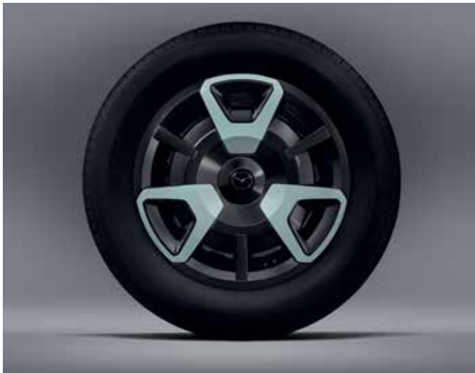
15" Stalen velgen met 2-tone wieldekseksels met bandenmaat 185/65 R15
