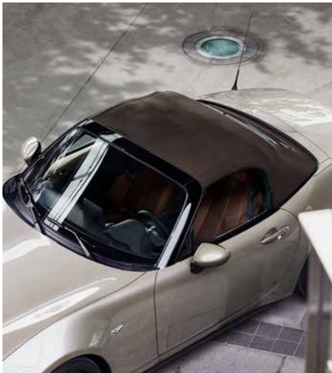
Capote brune souple avec isolation à ouverture manuelle (uniquement sur Roadster)
