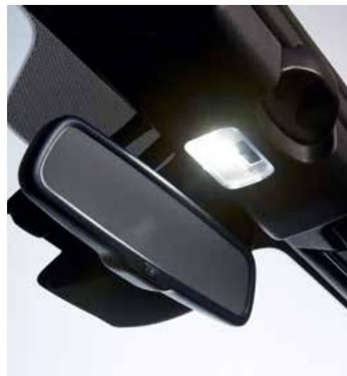
Éclairage intérieur LED
