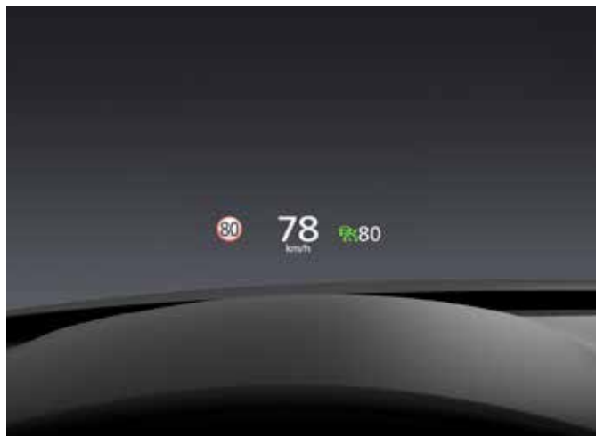
Head-up display in kleur met projectie op voorruit (ADD)
